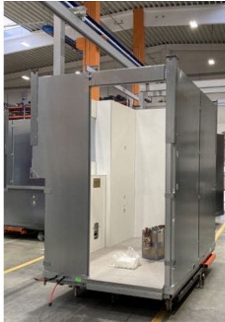
Innovativ und im Wohnungsbau noch eine Besonderheit: Vorgefertigte Bäder
